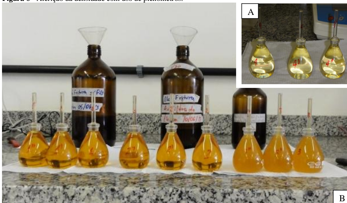
Figura 6 - Aferição da densidade com uso de picnômetros:
