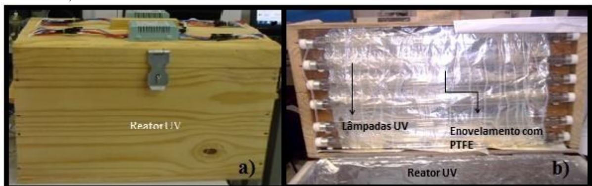
Figura 14 – Foto do reator UV para a geração de hidretos em linha:
