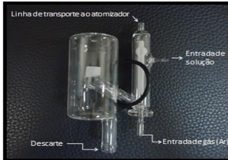
Figura 11 - Separador gás-líquido do sistema de injeção para a geração dos hidretos.
