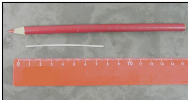
**Figura 7** – Foto da fibra porosa de polipropileno.
