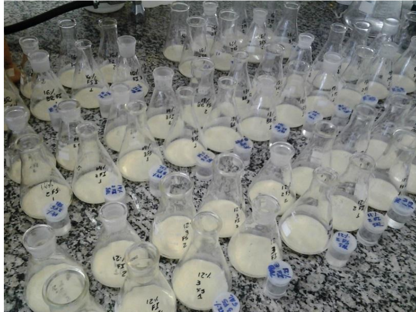
Figura 2.1 - Experimentos de determinação da atividade da Lipase após o processo de partição.
