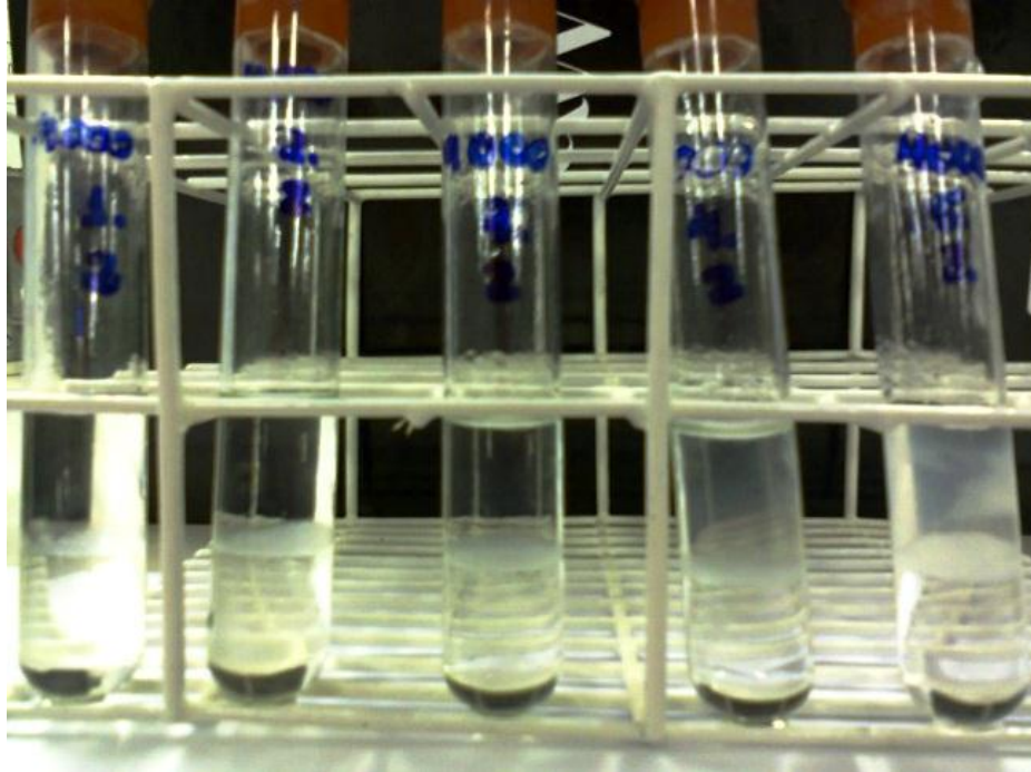
Figura 2.19 - Sistemas aquosos bifásicos formados por PEG 4000 \text{g mol}^{-1} + citrato de sódio + água a 25,0 °C, com distribuição da lipase na interface.
