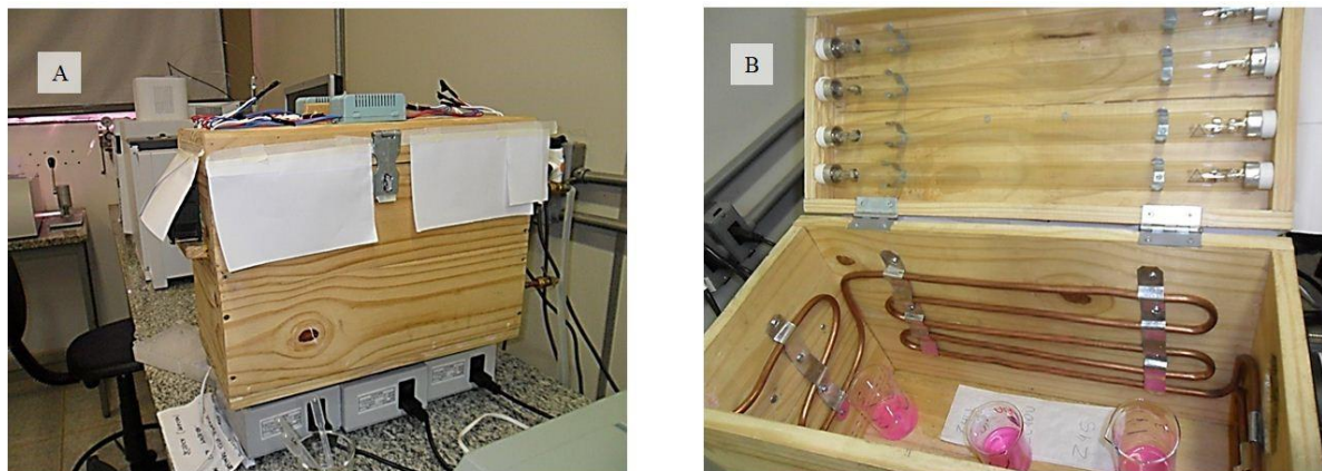
Figura 6 – Reator fotoquímico empregado para análises com radiação UV-C:
