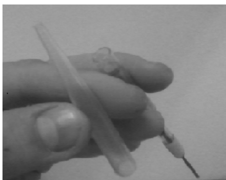
Figura 8: Eletrodo de trabalho utilizado durante os experimentos.
