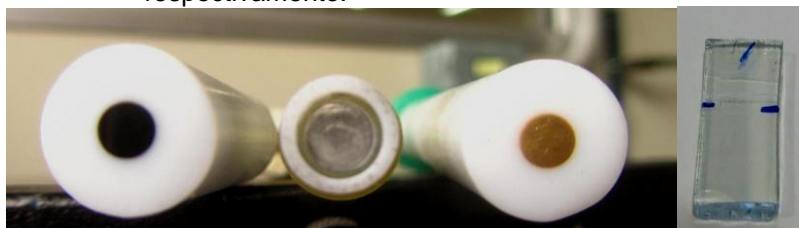
Figura 1 – Eletrodos de carbono vítreo, platina, ouro e FTO , respectivamente.
