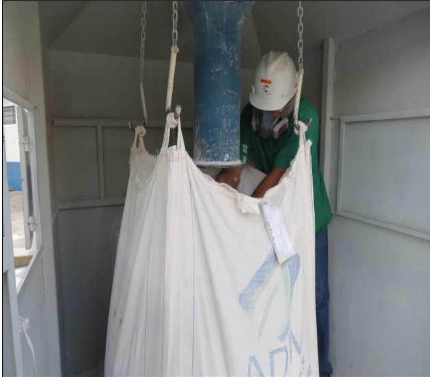
Figura 16 - Amostragem do material coletado no *Underflow* do ciclone.
