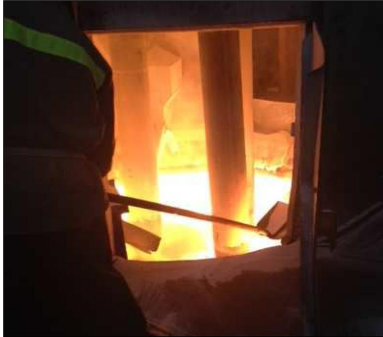
Figura 12 - Amostragem do material sendo alimentado no forno.
