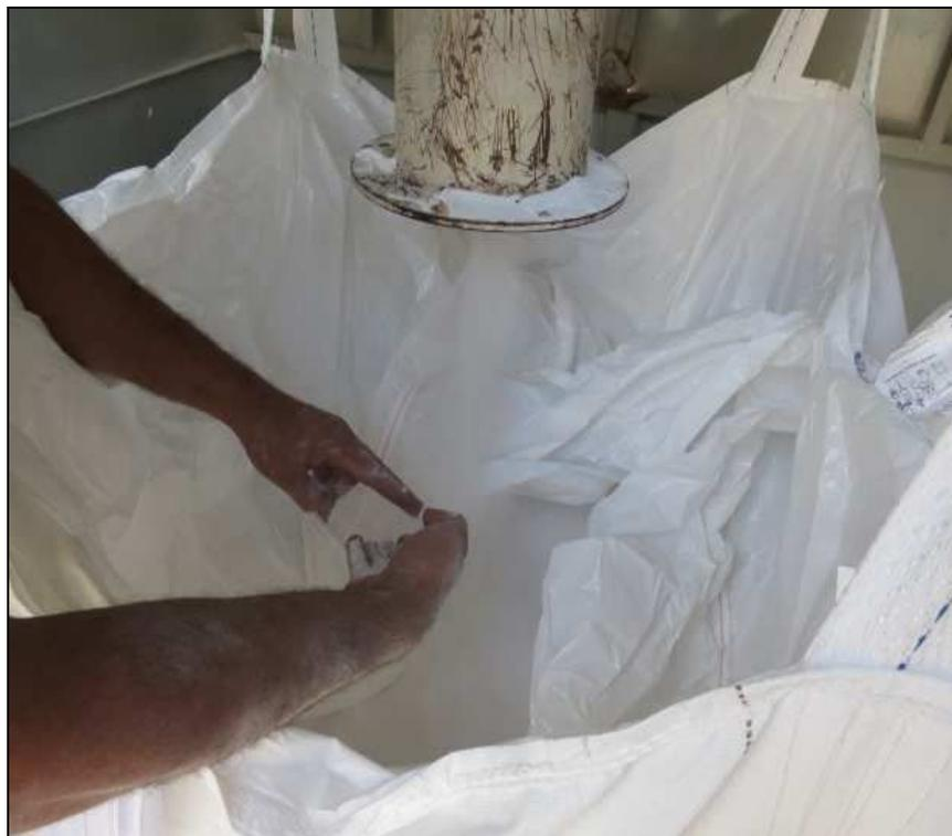
Figura 17 - Amostragem do material retido no filtro manga.
