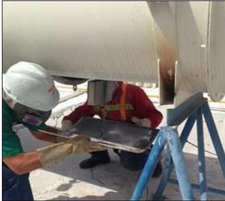
Figura 14 - Forma de abertura e fechamento do ponto de amostragem.
