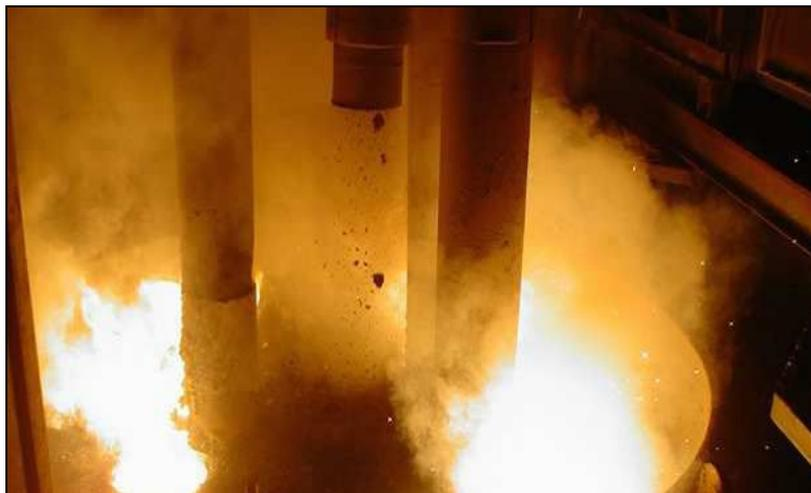
Figura 2 - Fuga de Material Particulado no forno elétrico.
