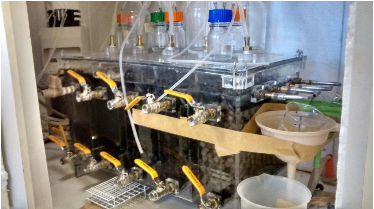
Figura 2 - Foto reator compartimentado no Laboratório de Engenharia de Alimentos FZEA-USP.
