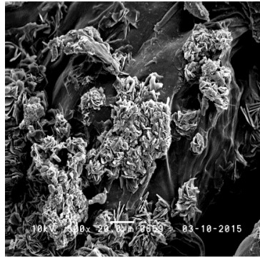
Figura 6 – Microscopia eletrônica de varredura do hidrogel quitosana-glicerol fosfato (em pó liofilizado): A) com aumento de 500x B) com aumento de 2000x.
