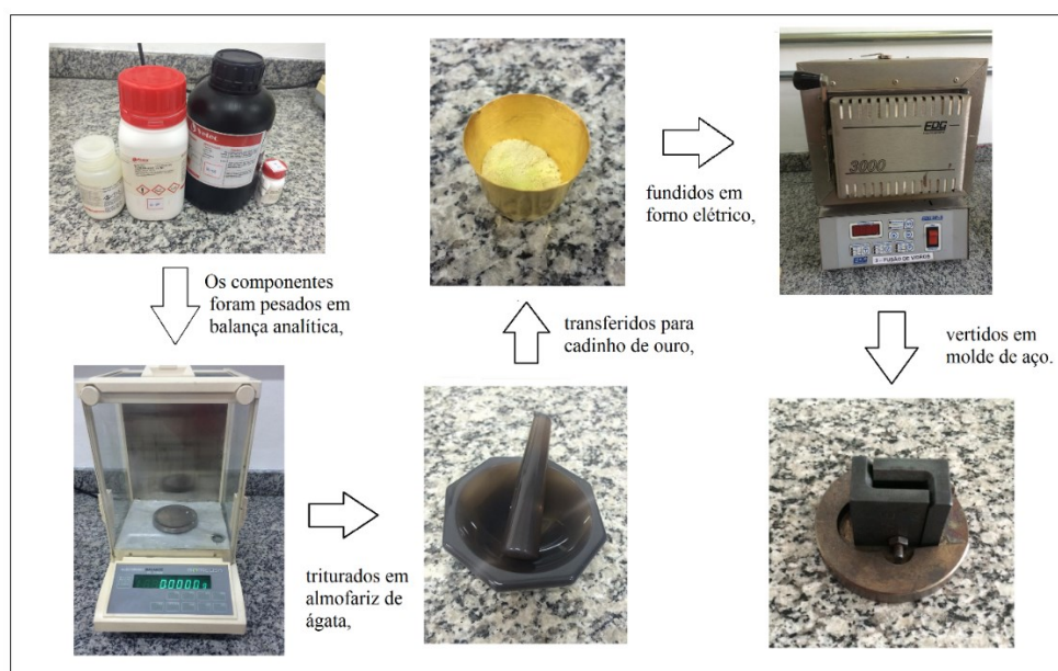
FIGURA 19 – Esquema de etapas de obtenção de amostras vítreas.
