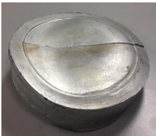
Figura 7- Rejeito de tarugo na extrusão (talão).
