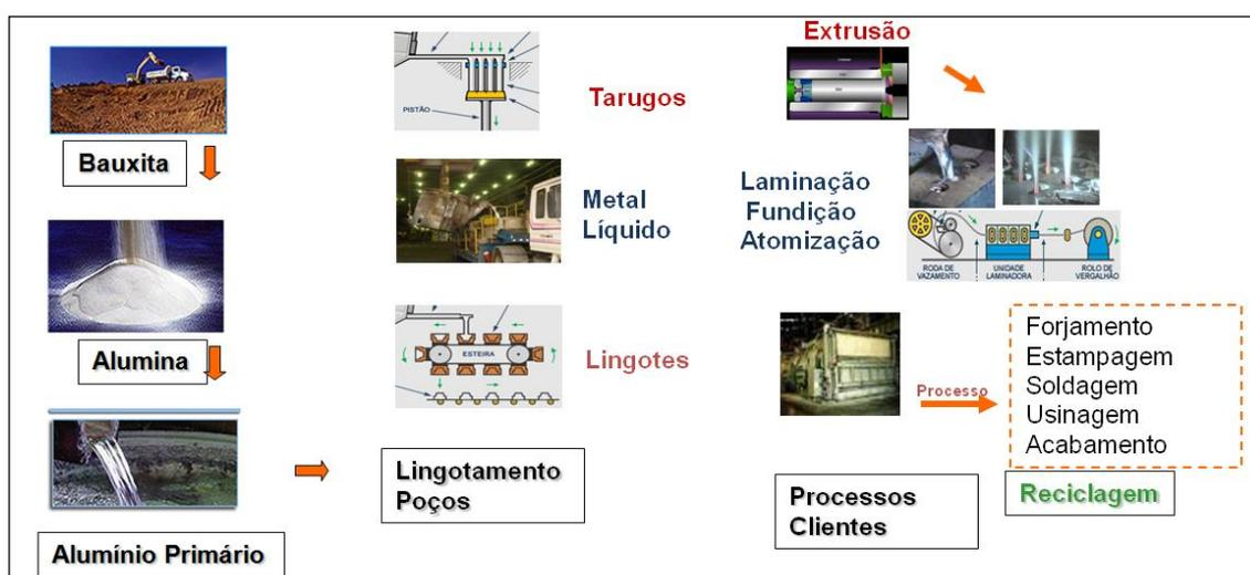
Figura 4 – Fluxograma de obtenção do alumínio e de produtos semi-acabados.
