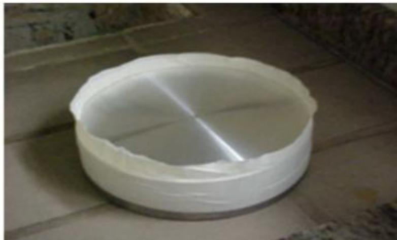
Figura 18 – Amostra do tarugo para ataque com água régia.
