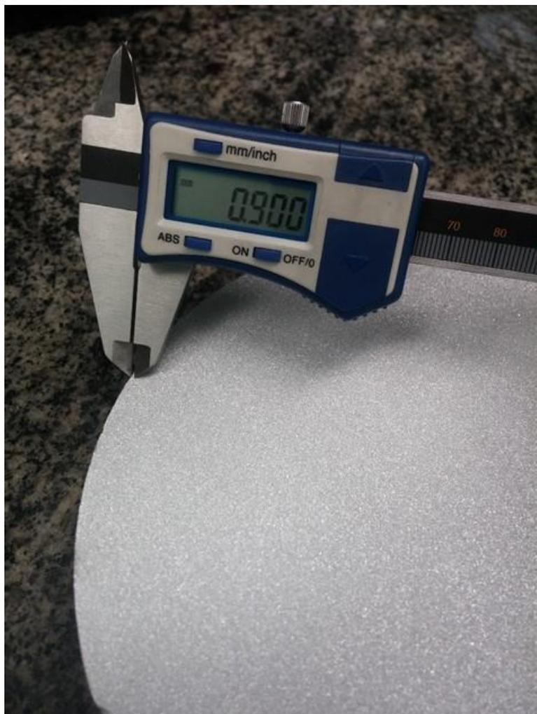
Figura 59 – Medição da camada de refusão de um tarugo com paquímetro.
