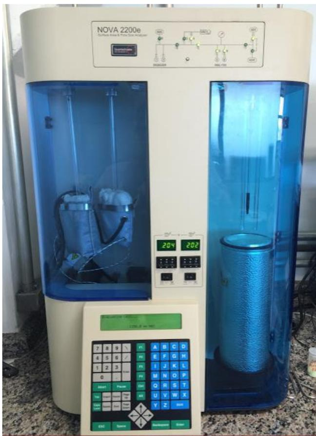
Figura 11 - Equipamento utilizado para a determinação de área superficial e do volume dos poros. (IP&D/Univap, São José dos Campos).
