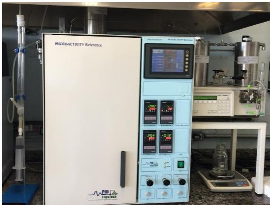
Figura 13 – Unidade de alta pressão e alta temperatura utilizada para avaliar a eficiência de catalisadores em um processo de hidrodessulfurização, instalado no IP&P/Univap, São José dos Campos.
