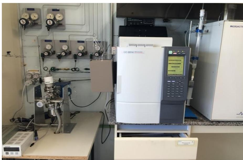
Figura 14 - Equipamento de cromatografia gasosa acoplado com a unidade de altas pressão e temperatura. (IP&D/Univap, São José dos Campos).
