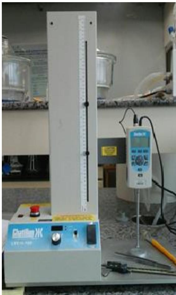
Figura 12 – Equipamento usado para a avaliação da resistência à compressão diametral dos catalisadores desenvolvidos nesse trabalho. (IP&D/Univap, São José dos Campos).
