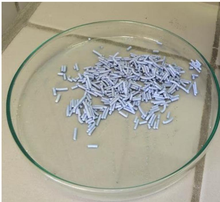
Figura 10 – Pellets cilíndricos durante o processo de impregnação.
