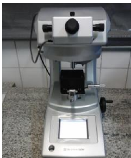
Figura 16 - Equipamento utilizado para medir microdureza. Fonte: Próprio autor.
