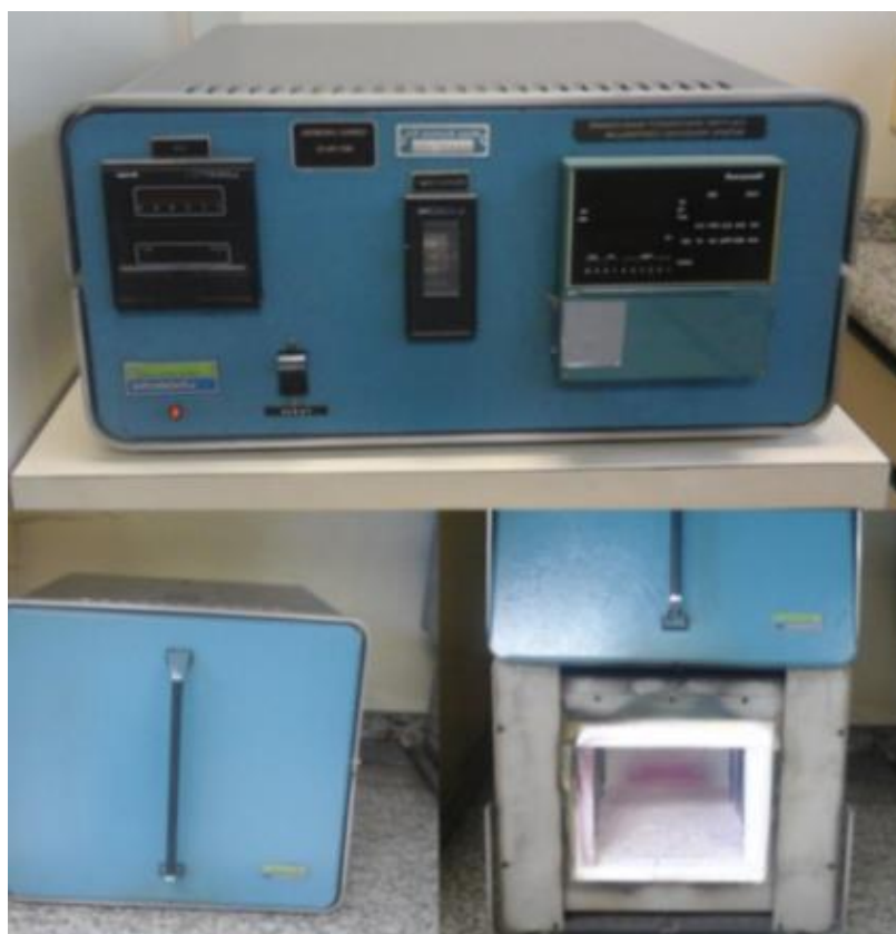
Figura 13 - Forno utilizado para a sinterização das amostras. Fonte: Próprio autor.
