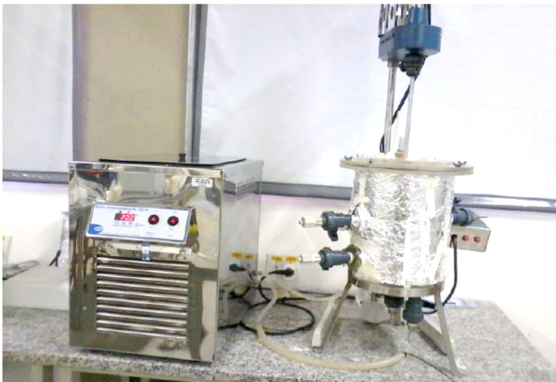
Figura 2 – Foto da montagem utilizada no estudo do tratamento da drenagem ácida de mina sintética.
