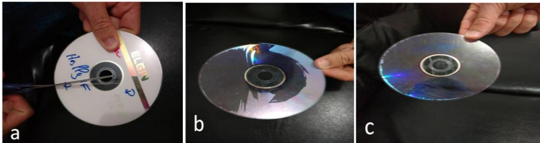
Figura 3. (a) Separação do DVD em duas partes, (b) Parte de baixo do DVD, (c) DVD com o centro tampado.
