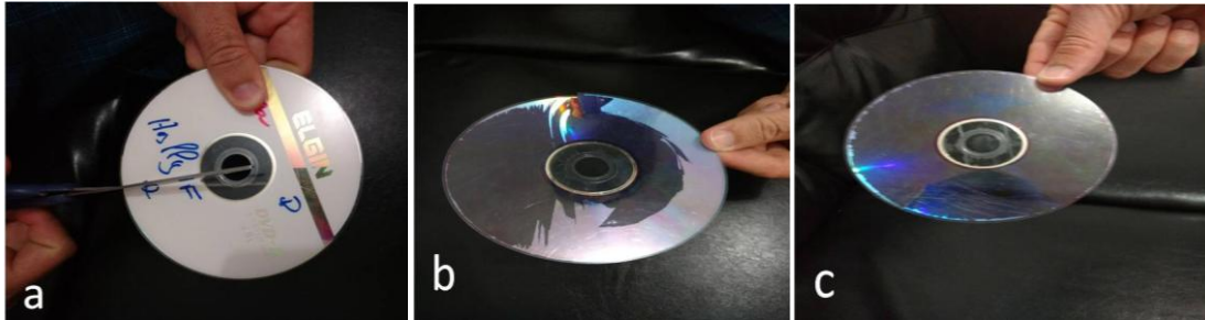
Figura 3. (a) Separação do DVD em duas partes, (b) Parte de baixo do DVD, (c) DVD com o centro tampado.
