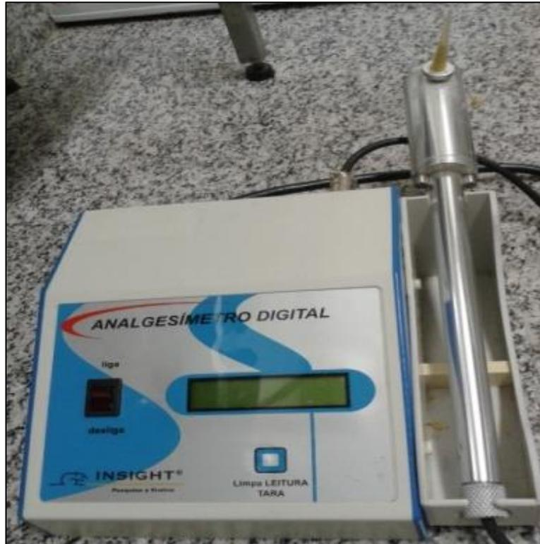
Figura 5- Aparelho para o teste de nociceção mecânica *von Frey* digital. Fonte do autor.
